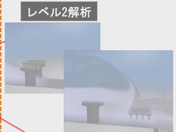
橋梁等の土木構造物の被害予測 (橋梁の流失被害)
